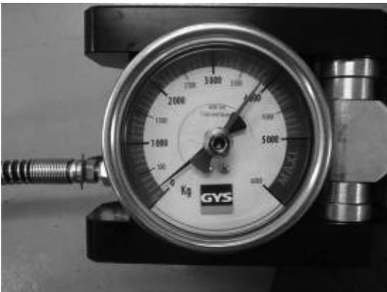
Durant le pompage les aiguilles indiquent la force de traction. Après rupture l'aiguille rouge reste à la force maximum.
