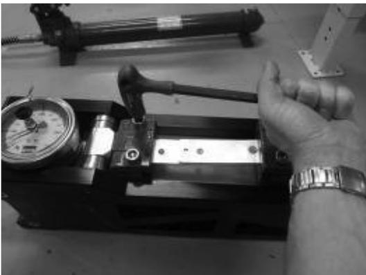
Insérer les tôles dans les mâchoires du banc de traction. Bloquer fortement les 4 vis avec une clé 6 pans de 10.
