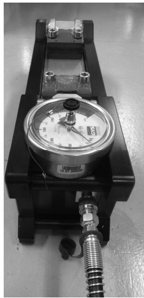
Enlever les embouts de protection et visser le flexible de la pompe sur le raccord du banc de traction.
